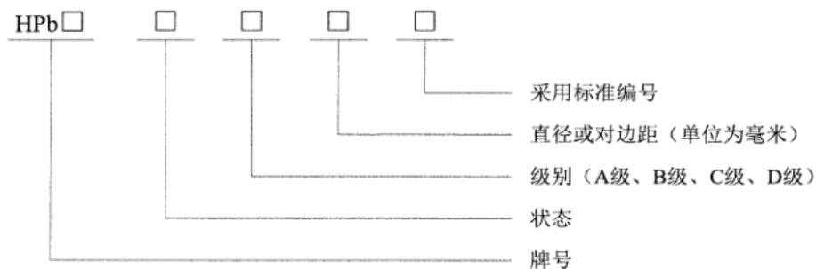
示例: 用牌号为 HPb63-3 制成的直径为 3.50mm, 直径极限偏差为 A 级的硬态磨光棒材。
