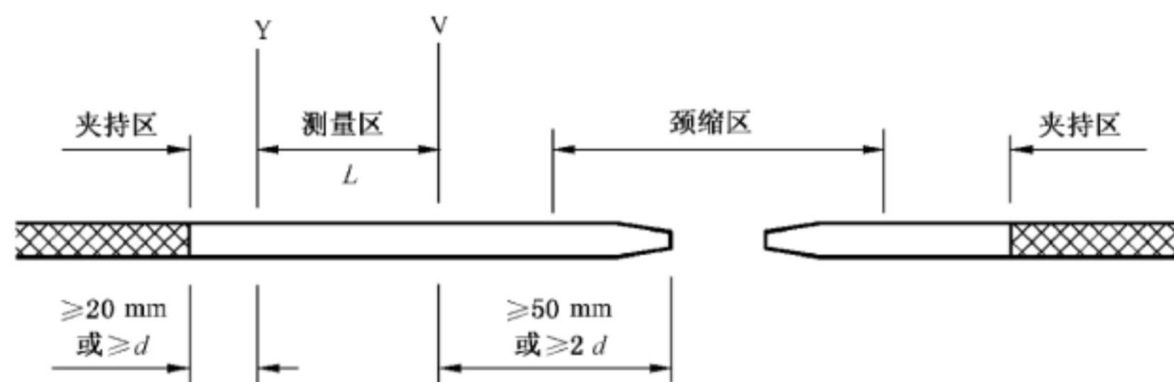
图 A.1 断裂后的测量
